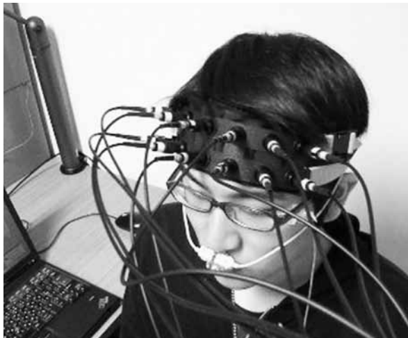
図 1. 予備実験での NIRS および呼気ガスモニタのプロープ配置。NIRS プロープは、1 対の照射ファイバと受光ファイバが 3 cm 間隔で交互に、2 × 6 の配列で配置した。このプロープ配置で前額部 3 cm × 15 cm の領域の脳血流を 16 チャンネルに分割して測定した
