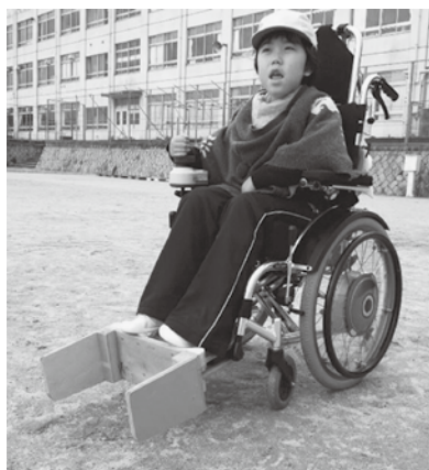
図5 電動車椅子に取り付けた木製フットガード
