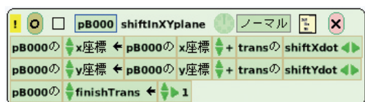
図11 グラフの点を表すモーフに定義した平行移動を行うスクリプト
